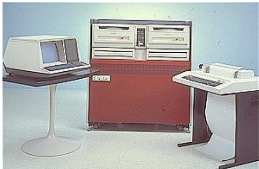
Le mini ordinateur PDP 11/60 (au centre), son terminal (à gauche), et son imprimante à aiguilles (à droite)
