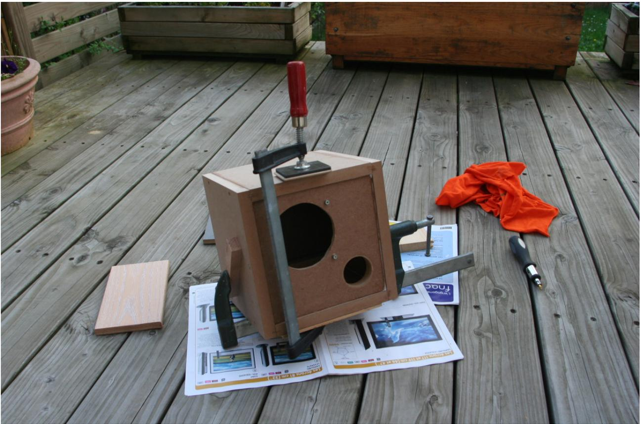
*Une fois la colle appliquée, on la laisse sécher une nuit en la maintenant avec des serres-joints.*
