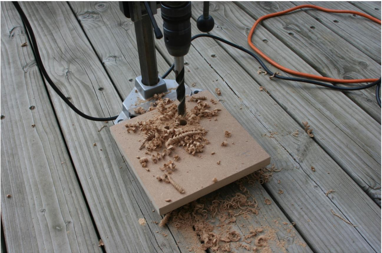
*Pré-perçage pour guider la scie-cloche.*
