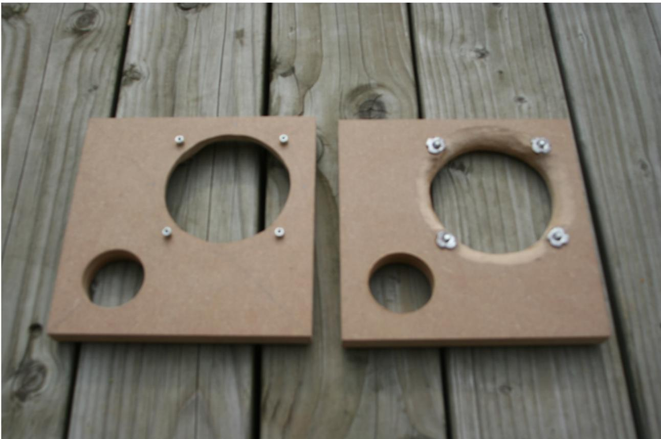
*La défonce faite avec une scie-cloche du diamètre adéquat.*
