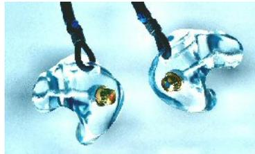
Ces bouchons peuvent être réalisés sur mesure, dans ce cas-ci un moulage du conduit auditif est nécessaire. Avantage, différents filtres pourront être appliqués selon l'utilisation, en général les filtres offrent une atténuation de 9, 15 et 25 dB. Ces bouchons offrent donc une meilleure protection pour les niveaux forts tout en gardant un équilibre fréquentiel, donc avantage pour les professionnels du son à pouvoir exercer leur métier en toute sécurité pendant une période prolongée.
